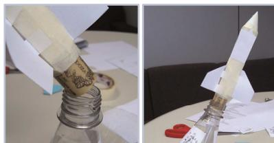
2 Coloque vinagre no interior da garrafa e o comprimido efervescente envolvido no guardanapo. Tampe a garrafa com a rolha acoplada ao foguete.
